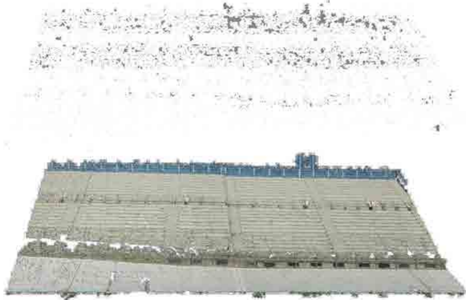
Fig._ Immagini della nuvola di punti densa della tribuna. In basso il dettaglio della struttura architettonica ottenuto dalla campagna fotografica. Numero totale di scatti: 257
