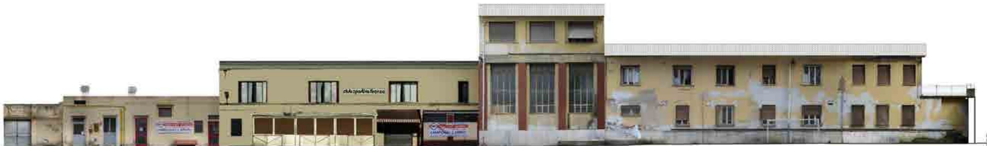
Fig_ Gli attuali software di fotogrammetria ci consentono di ottenere elaborati prospettici di altissima qualità. In questo caso con l'uso di Photoscan, otteniamo il riconoscimento automatico dei punti omologhi comuni a più immagini fotografiche.
