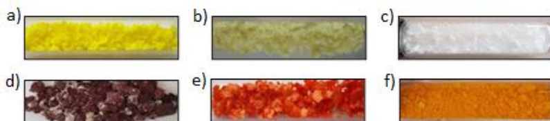
Figure 33 Images of the prepared samples a) \text{DA}_2\text{SnBr}_4 , b) \text{DA}_2\text{GeBr}_4 , c) \text{DA}_2\text{PbBr}_4 , d) \text{DA}_2\text{SnI}_4 , e) \text{DA}_2\text{GeI}_4 , and f) \text{DA}_2\text{PbI}_4 .
