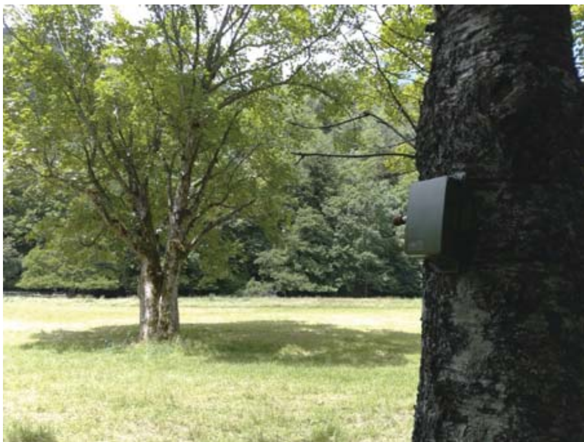
Fig. 8 - Registratore Wildlife Acoustics SM4BAT-FS installato nella piana della Lama a una altezza di circa 2.5 metri.
