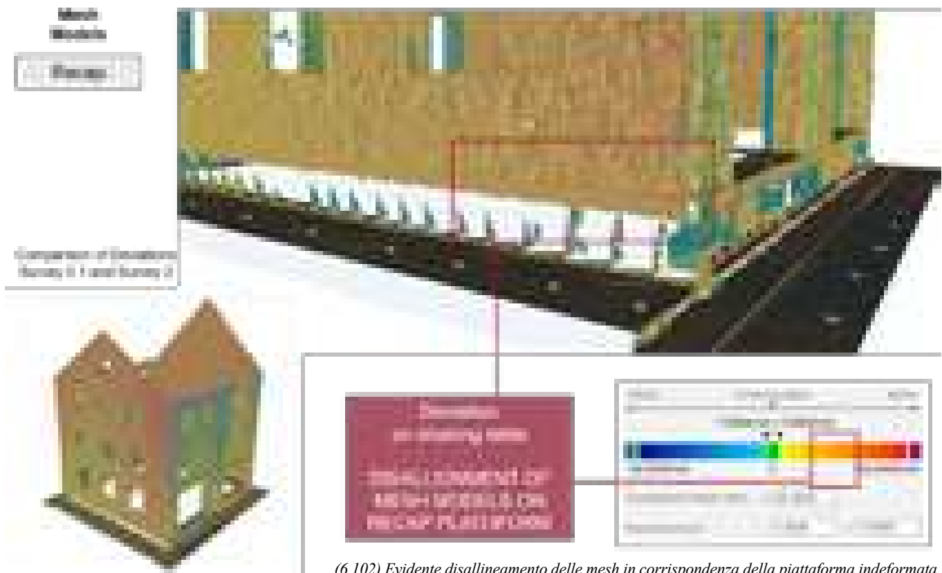
(6.102) Evidente disallineamento delle mesh in corrispondenza della piattaforma indeformata.
