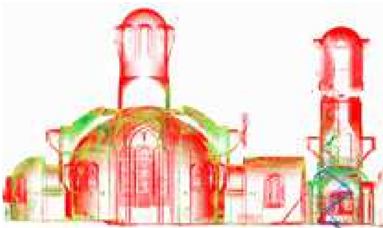
(5.51) Involucro interno dell'apparato strutturale del complesso di Taman, in Upper Kama (Russia). La calibrazione di adeguate mappe colore può essere variata anche nella sola visualizzazione della nuvola di punti per evidenziare, attraverso riflettanza e grado di incidenza, le principali variazioni formali diffuse.
