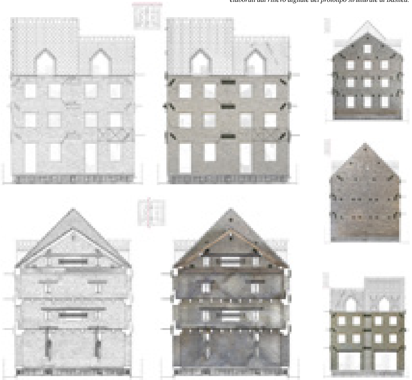
(6.66-6.72) Disegni vettoriali CAD integrati ai fotopiani materici elaborati dal rilievo digitale del prototipo strutturale di Basilea.
