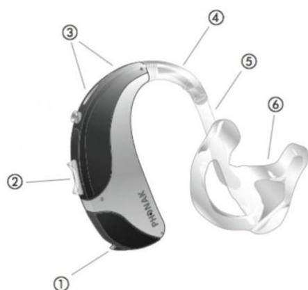
Figura 8: Protesi acustica retroauricolare per via aerea. Schema esemplificativo delle diverse componenti: 1: vano batteria; 2: controllo del volume; 3: microfono; 4: curvetta di raccordo; 5: tubo di raccordo; 6: auricolare (da <https://phonak.com>)
