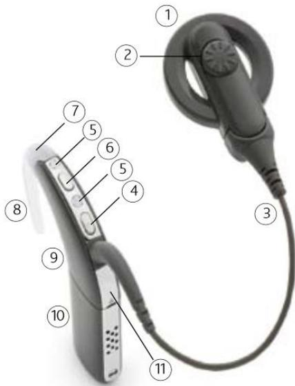
Figura 12: Impianto cocleare - parte esterna. Componenti: 1: Bobina; 2: Magnete della bobina; 3: Cavo della bobina/cavetto; 4 e 6: Pulsanti regolazione volume e programmi; 5: Microfoni; 7: Spia luminosa (batteria e programma in uso); 8: Curvetta; 9: Unità di elaborazione/speech processor; 10: Vano batteria; 11: Cover della presa degli accessori (<https://www.medel.com>)
